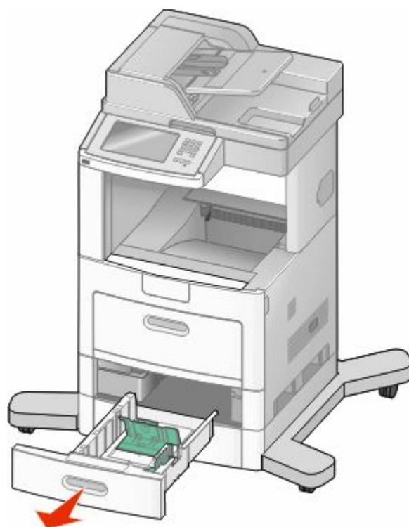
**2** Нажмите на фиксатор направляющей ширины бумаги, как показано на рисунке, и передвиньте направляющую в положение, соответствующее формату загружаемой бумаги.
