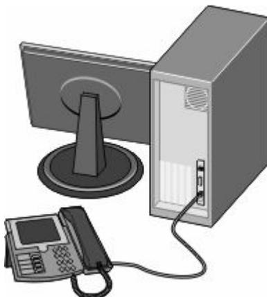
5 Соедините третьим телефонным кабелем модем компьютера и порт EXT
