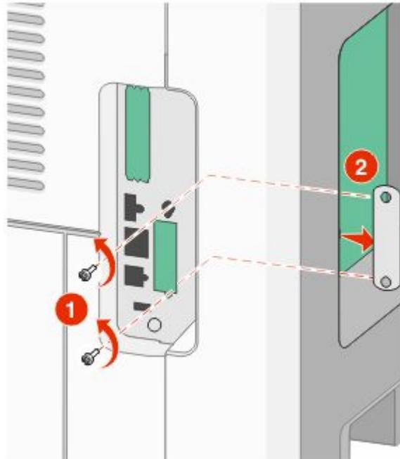
**4** Вставьте плату факса и прикрепите ее с помощью двух прилагаемых винтов к установочному кронштейну.
