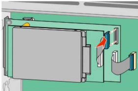
Чтобы установить жесткий диск принтера непосредственно в системную плату:
