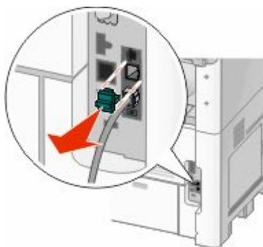
2 Подключите требуемое телекоммуникационное оборудование непосредственно к порту EXT
