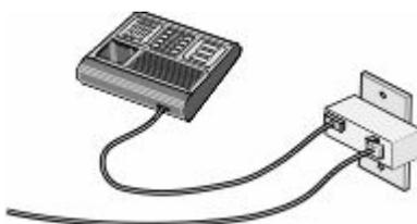
Если для телекоммуникационного оборудования используется телефонная линия типа US (RJ11), выполните приведенные далее шаги для подключения телекоммуникационного оборудования.
