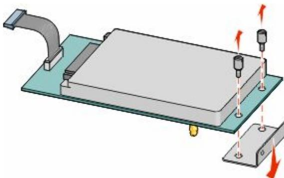
4 Снимите металлическую крышку с отверстия порта ISP.
