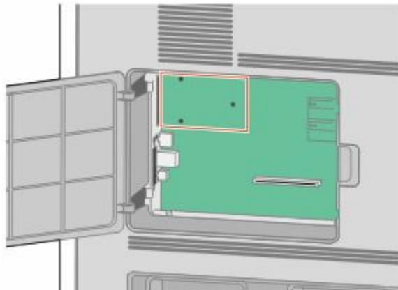
**Примечание.** Если установлен дополнительный порт ISP, то жесткий диск принтера необходимо установить в порт ISP.
