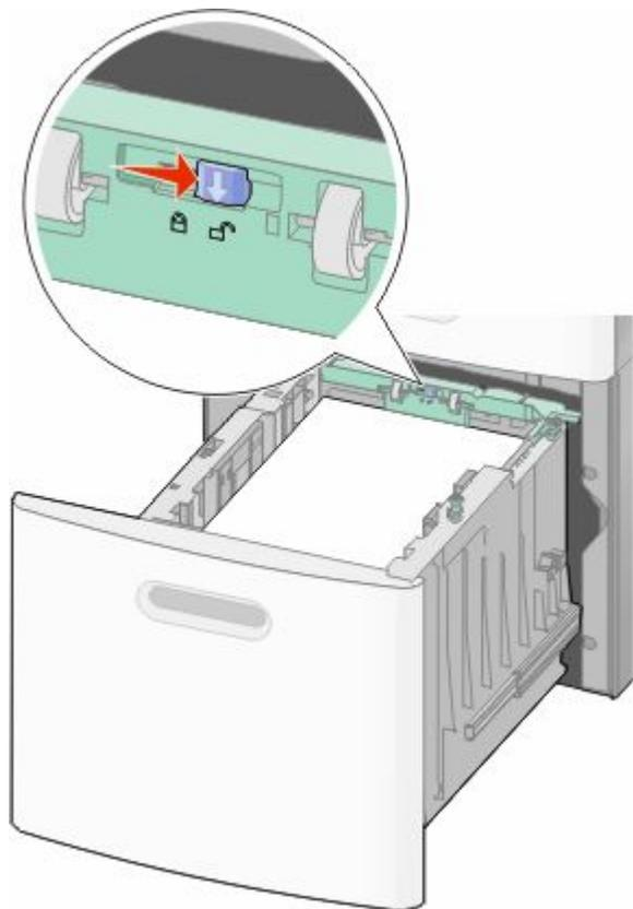
**4** Нажмите на фиксатор направляющей длины, чтобы поднять ее, сдвиньте направляющую в положение, соответствующее бумаге, загружаемого формата, а затем зафиксируйте направляющую.
