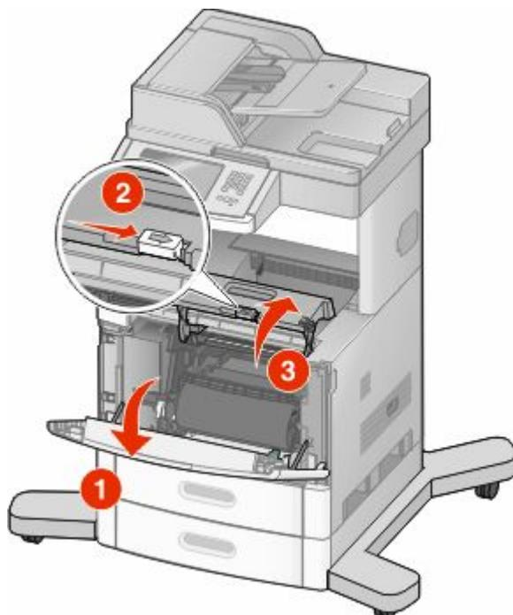
4 Поднимите и извлеките картридж из принтера.
