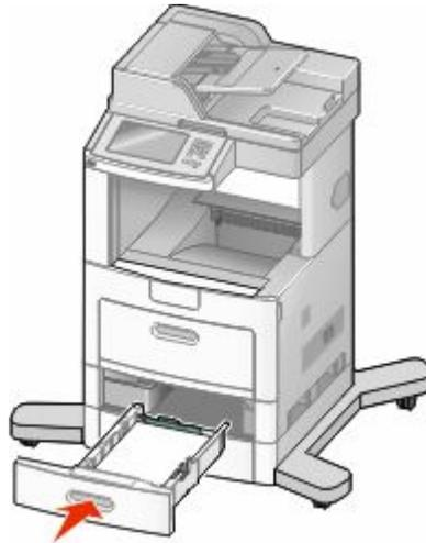
8 Если в лоток была загружена бумага, тип которой отличается от того, что был загружен ранее в лоток, измените параметр типа бумаги для лотка, используя панель управления принтером.
